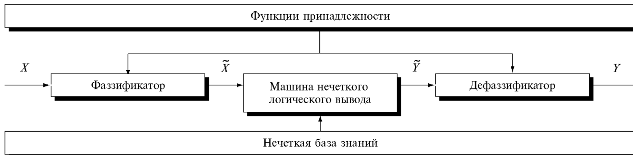
Рис. 1. Типовая структура нечеткой модели.
