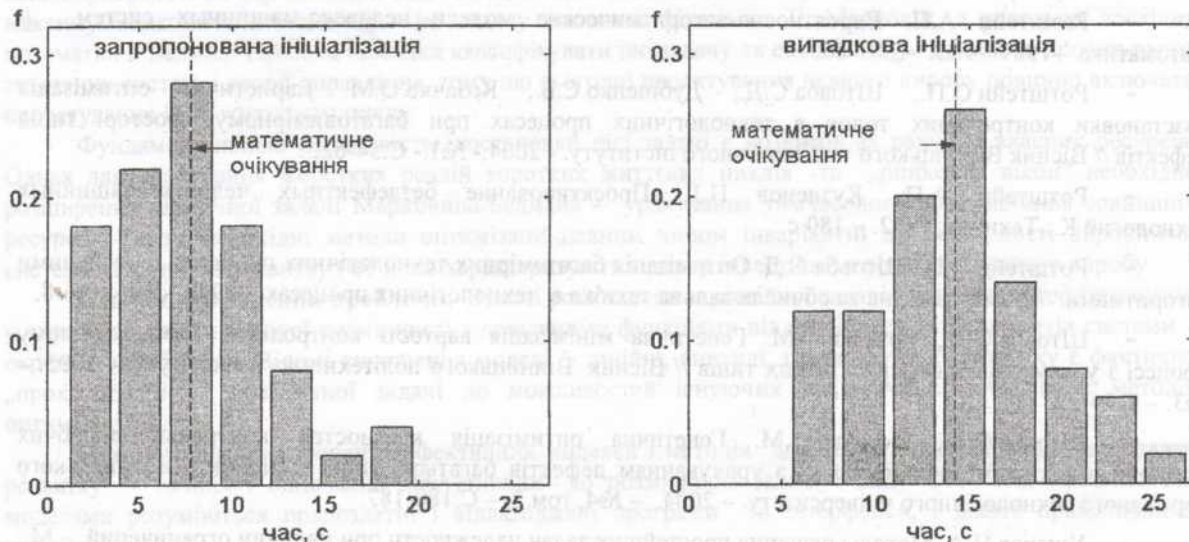
Рис. 1 Порівняння запропонованої і типової процедур ініціалізації популяції для задачі розподілу контрольних точок
